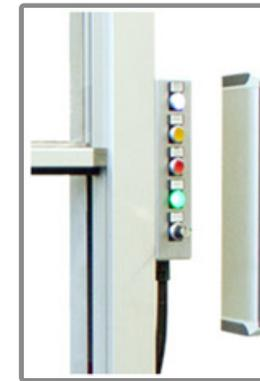
pulsantiera di comando con funzioni di avviamento, posizionamento, reset ciclo di lavoro, funzione auto, funzione manuale per manutenzione (particolare ricavato dal pieno)
